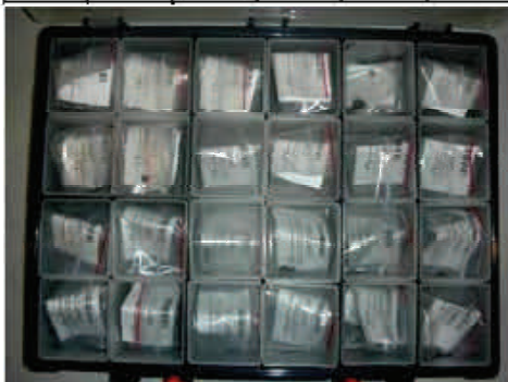
Cassetta con spessori da 1,40 mm a 1,86 mm con passi da 0,02 mm
